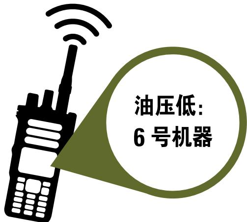
技术人员通过对讲机收到来自工厂报警和控制系统的短信息，显示有一台机器油压低。
