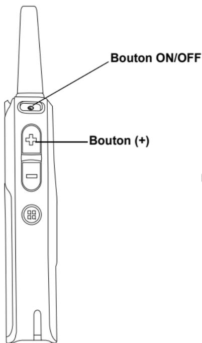
Mettez la radio sous tension avec le bouton ON/OFF tout en enfonçant simultanément les boutons PTT et (+) pour accéder au mode de configuration avancée.
