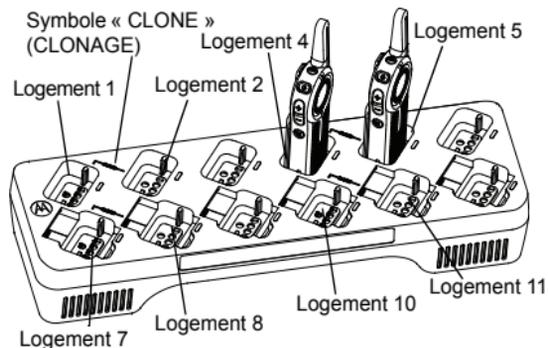
Pour cloner des radios en utilisant le MUC, vous devez disposer d'au moins deux radios :
