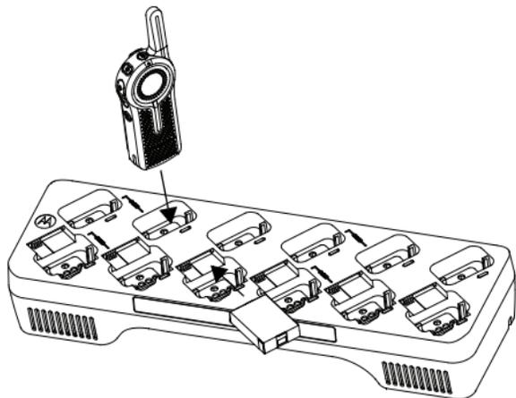
Le chargeur multi-unités à 12 compartiments DLR (MUC) permet de charger jusqu'à 12 radios ou jusqu'à 6 radios et 6 batteries autonomes. Les batteries peuvent être chargées à l'intérieur ou à l'extérieur de la radio; elles peuvent en outre être placées séparément dans le MUC. Chacun des 12 compartiments de charge peut loger une
