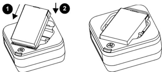
Pour charger une batterie, insérez la batterie dans le logement du chargeur comme suit :
