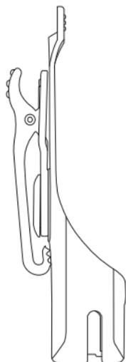
1. Insérez la radio dans la partie inférieure de l'étui en l'inclinant. Poussez la radio dans le fond de l'étui jusqu'à ce que les crochets de l'étui reposent dans les encoches supérieures de la batterie.
