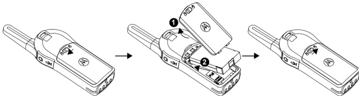
1. Faites glisser le loquet situé dans le haut du couvercle de la batterie en position de déverrouillage
