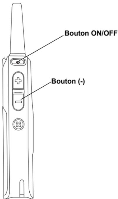
Allumez la radio en appuyant sur le bouton ON/OFF tout en enfonçant simultanément les boutons PTT et (-) pour accéder au mode de clonage.
