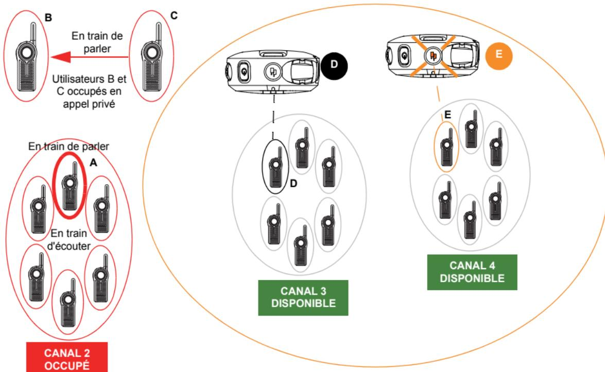
6. L'utilisateur E appuie sur le bouton PTT pour parler avec l'utilisateur D. Les deux utilisateurs sont maintenant engagés dans une conversation privée. Personne d'autre ne peut les entendre. Le voyant à DEL du bouton supérieur des radios D et E s'allume **en orange et en continu**.
