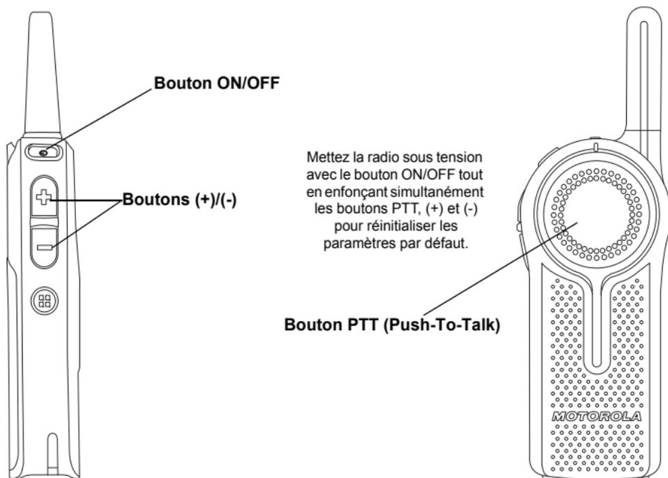
**Paramètres d'usine par défaut de la radio**
