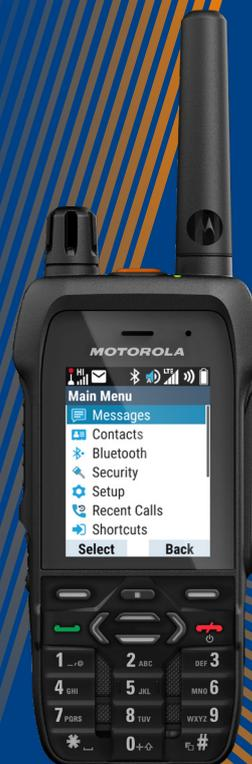
La MXP660 es una radio portátil TETRA resistente, ligera y muy funcional, con función LTE integrada y fácil de transportar y de usar. Para que los mensajes vitales se transmitan, la MXP660 tiene la opción de aumentar a la potencia de transmisión TETRA de clase 3. Si un usuario de la MXP660 se sale de la cobertura TETRA, la radio puede cambiar automáticamente a la banda ancha LTE o Wi-Fi disponible, a la vez que mantiene las funciones y flujos de trabajo de DIMETRA™ a través de DIMETRA Connect.
