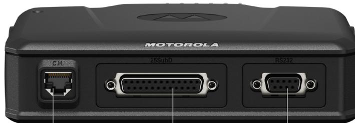
CONNETTORE DEL FRONTALINO DI CONTROLLO RJ50
